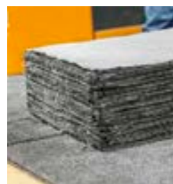
Die i3-Produktion: Aus Carbonfasern werden Matten (oben) geflochten. Diese werden zur Rohkarosserie (links oben) laminiert, anschließend auf ein Aluchassis gesetzt (links). Das klassische Presswerk und eine Lackiererei entfallen somit
