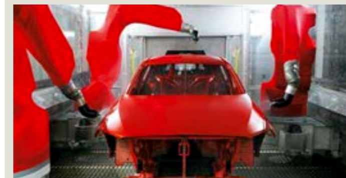
Der heute noch übliche Weg: Eine Stahlblechkarosserie wird von Robotern lackiert. Je effizienter dies geschieht, desto besser für Bilanz und Umwelt
